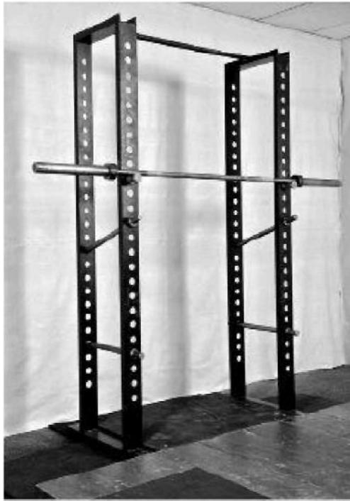
*Рисунок 8-8.* Наилучшие силовые рамы очень массивные. Рама на рисунке сварная, выполнена из четырех вертикальных направляющих из 12-см швеллера, с расстояниями между центрами отверстий равными 7,5 см, с жесткими втулками-ограничителями и перекладиной для подтягиваний, а также полом из усиленной швеллером плотной многослойной фанеры, и упорами из толстых болтов. Чертеж этой рамы представлен на [Рисунке 8-10](#).
